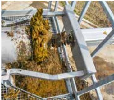
Die Festphase der Gärreste fällt aus der Pressschnecke und wird anschließend auf einer Mistplatte gelagert.
