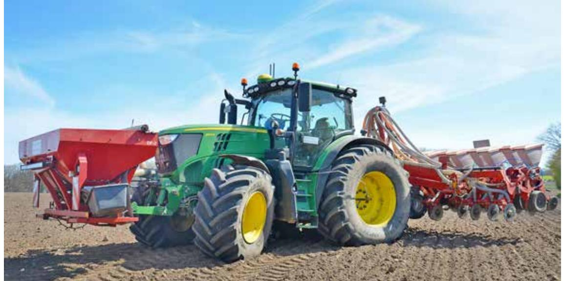
Standardschlepper mit Einzelkornsämaschine, Frontdüngertank und Reifendruckregelanlage Fotos: Julian Haase
