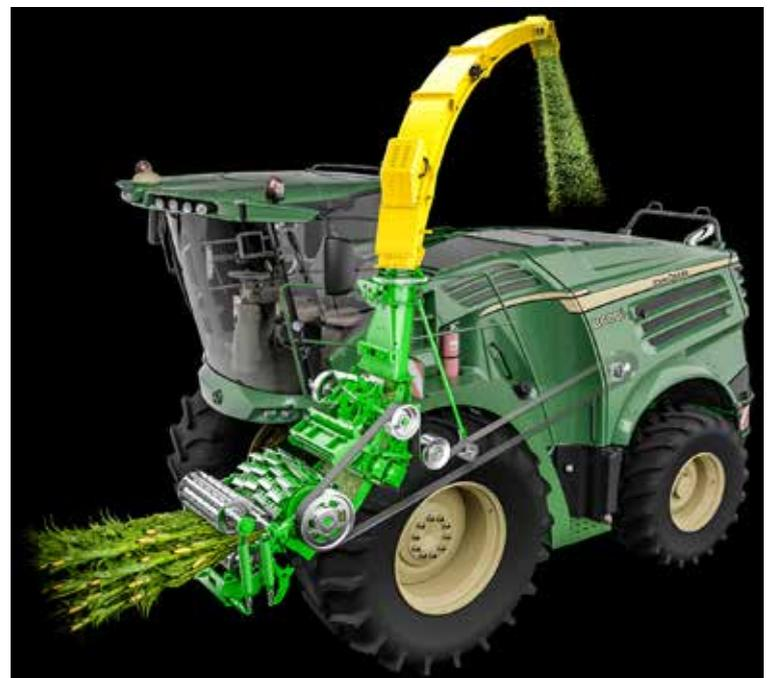
Gutfluss von Mais im Feldhäcksler (vier Vorpresswalzen, Segmentmesserhäckseltrommel, Körnerprozessoren, Wurfbeschleuniger, Auswurfkrümmer mit NIRS-Sensor)
