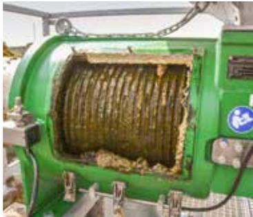
Die Pressschnecke erzeugt einen Druck von bis zu 6 bar.
