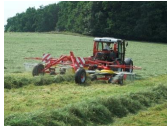
Zetten/Schwaden bei mäßigem Anwelkgrad bis 65 % TM (✓)
