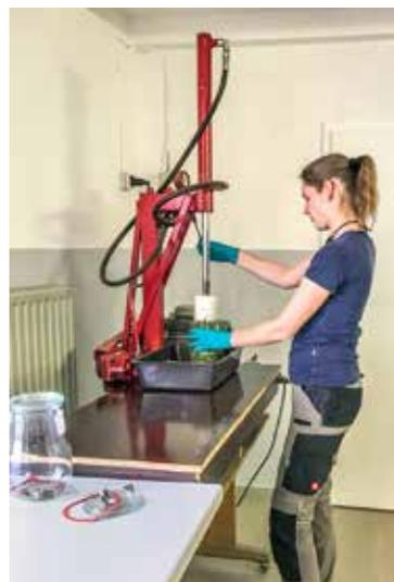
Parallel zur Silierung im Rundballen wurde ein Begleitversuch in der modernisierten Versuchsstation Futterkonservierung angelegt. Für den Versuch im Labormaßstab werden Weckgläser verwendet, in die das Erntegut gepresst wird.
