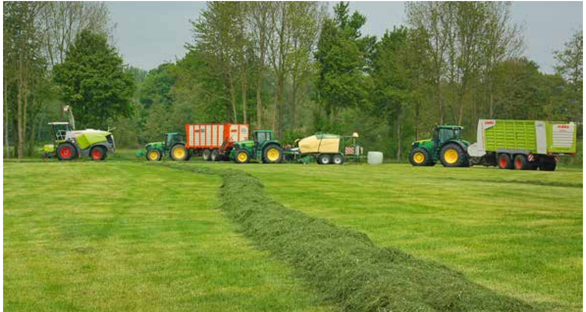
Die Grassilage wurde mit Feldhäcksler, Ladewagen und Press-Wickel-Kombination parallel, schwadweise versetzt geerntet. Fotos (2): Dr. Klaus Hünting
