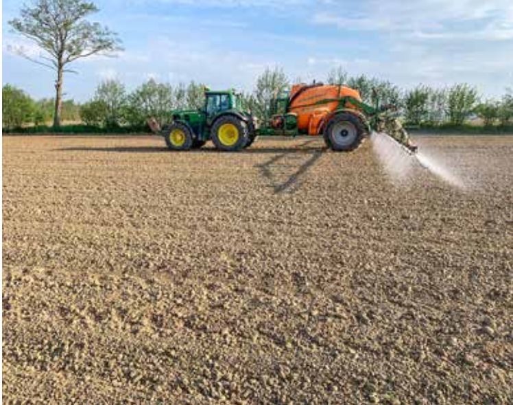
Herbizidanwendungen mit Doppelflachstrahldüsen haben sich im Rübenanbau bewährt. Foto: Frank Jeche
