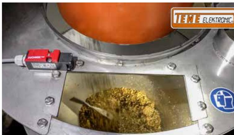
Blick in die Schleusenkammer, bevor der Mais über Luftdruck verschickt wird
