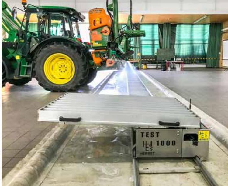
Geprüft werden unter anderem die Pumpenleistung, Leitungsdichtigkeit und die Querverteilung. Fotos: Dr. Wolfgang Pfeil
