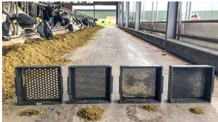
Vierteilige Schüttelbox mit den jeweiligen Anteilen auf der Siebebene davor Foto: Hochschule Osnabrück
