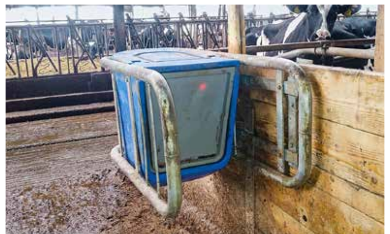
Um Ergänzungsfutter zu erhalten, wird die Ohrmarke der Kuh durch die in der grauen Frontklappe eingebaute Antenne erkannt und nach Anheben der Klappe eine Futterportion ausgegeben. Fotos: Dr. Ole Lamp
