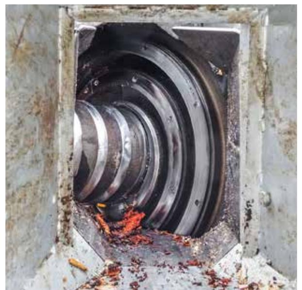
Einzugs- und Schneidwerkzeug des Schneckenhackers
