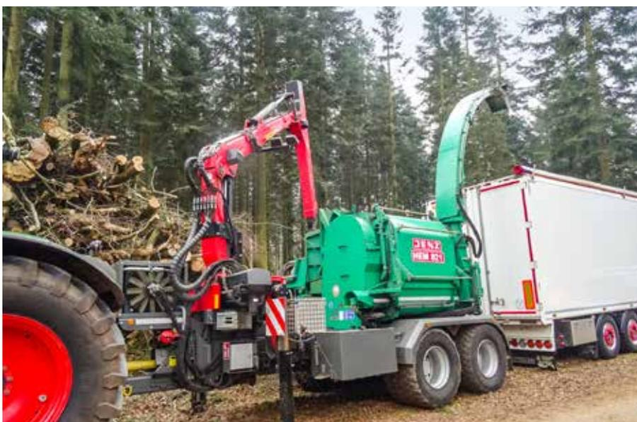
Anhängetrommelhacker mit Schlepperantrieb
