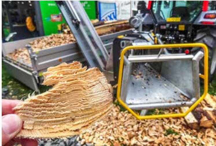
Bei diesem Schneckenhacker von Alvatec wird das Holz quer zu den Jahresringen geschnitten und „aufgefächert“, was eine beschleunigte Trocknung der Hackschnitzel unterstützt.
