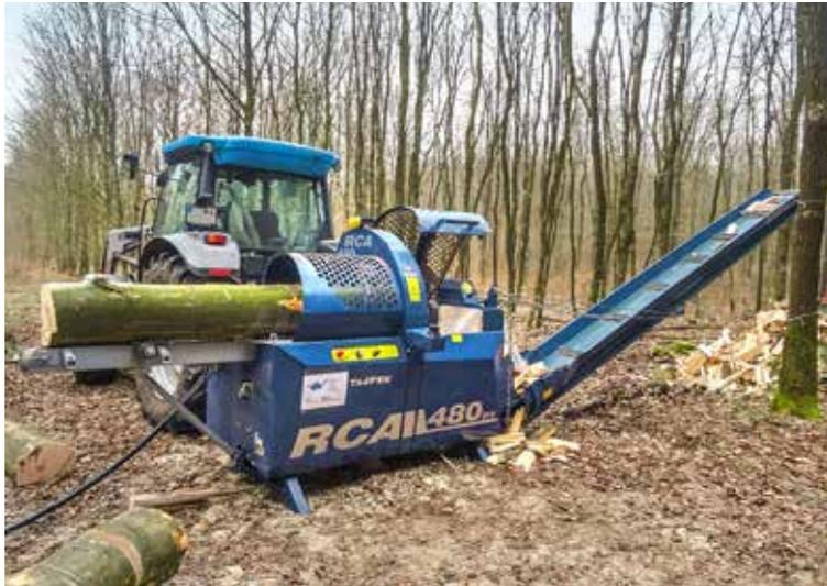
**Schneidspalter:** Der Stamm wird auf die gewünschte Länge gesägt und gespalten.
