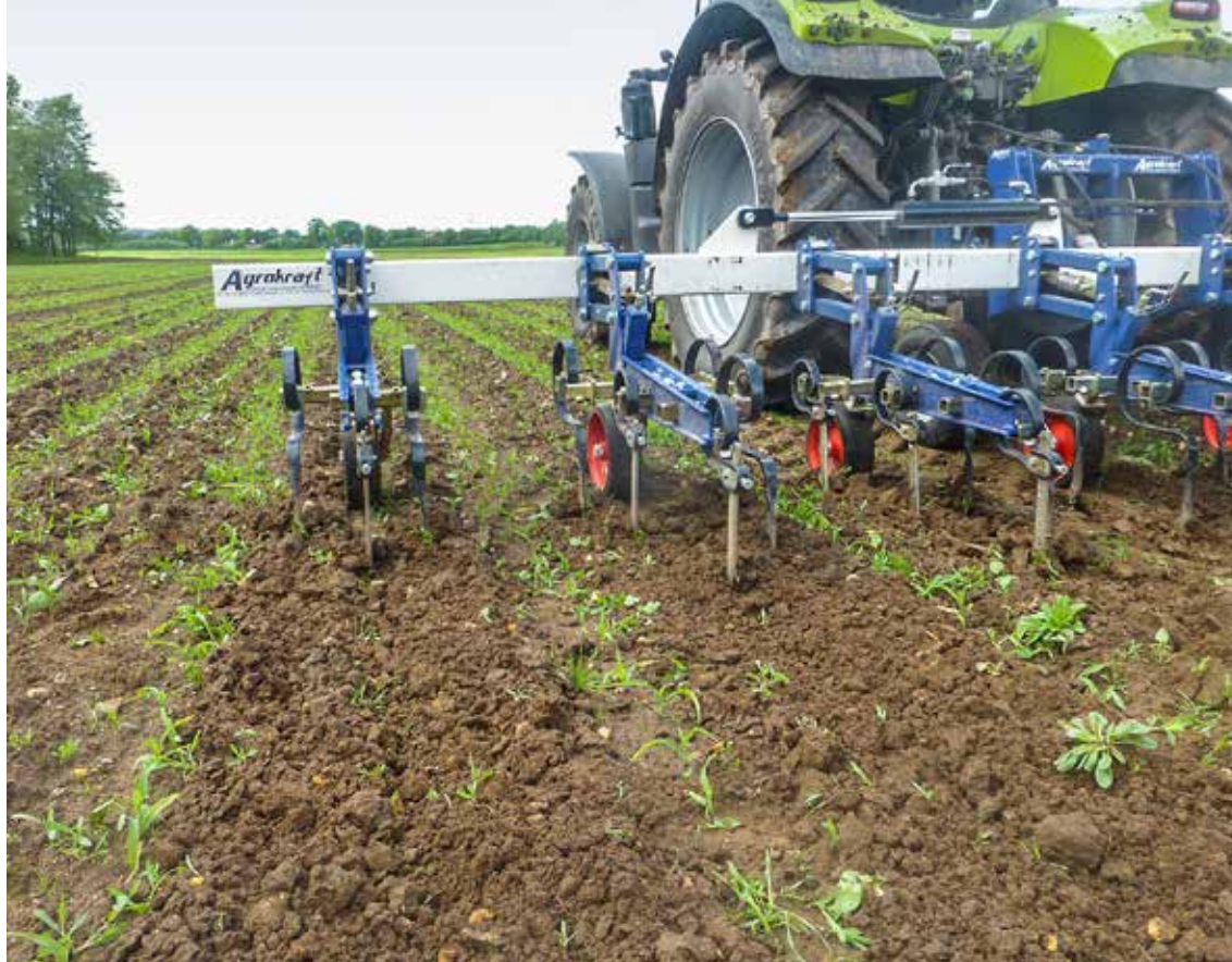
Diese Reihenhacke kann über den Maschinenring Mittelholstein solo gemietet werden. Schlepperspur, Stellung der Hackschare und Reihenabstand müssen im überbetrieblichen Einsatz zusammenpassen.
