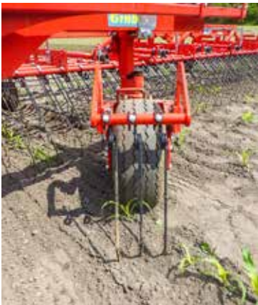
Striegelzinken hinter dem Stützrad verhindern das Wiederauwachsen ausgerissener Unkräuter in der Fahrspur.
