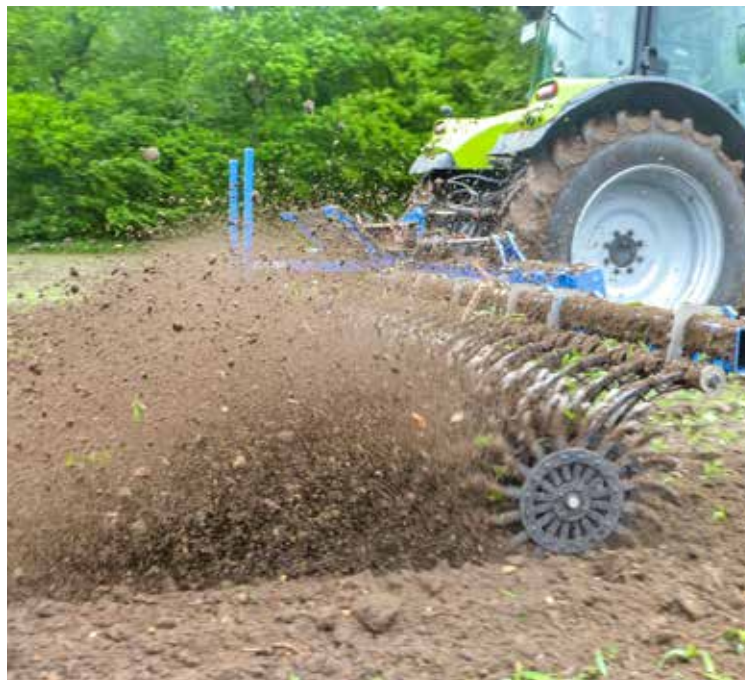
Mit einer Arbeitsgeschwindigkeit von 15 bis 20 km/h wirbelt die Rotorhacke Boden und Unkräuter auf. Die leichteren Pflanzen landen auf der Oberfläche und vertrocknen.
