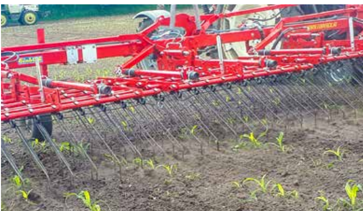
Je älter die Maispflanzen, desto steiler müssen die Striegelzinken eingestellt werden. Mit etwas Erfahrung kann bis zum Sechsstadium gestriegelt werden.
