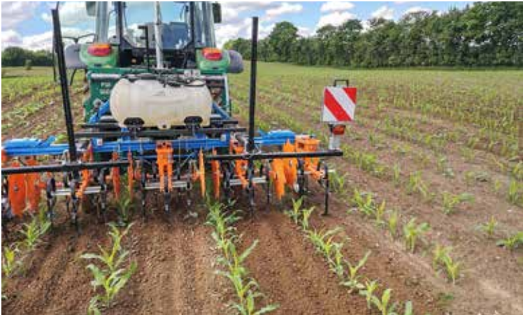
Mais wird mit der Hacke bearbeitet, erkennbar ist auch der Tank für die Bandspritzeinrichtung.
