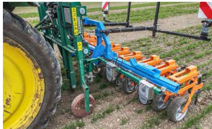
Ultraschallsensoren erkennen die Reihe des Sommerhafers und steuern den Verschieberahmen und die angebaute Hacke.
