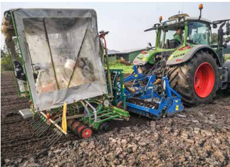
Aussaat der Roggenversuche mit einem Reihenabstand von 25 cm. Der Verschieberahmen wird GPS-gesteuert, diese Linie wird aufgezeichnet und beim Hacken erneut abgefahren.
