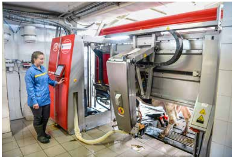
Anhand verschiedener Szenarien wird die Wirtschaftlichkeit beurteilt. Bei Arbeitskräftemangel und geringfügiger Reduzierung der Herdengröße wäre hier der Einsatz eines Melkroboters eine kostensparende Alternative.
