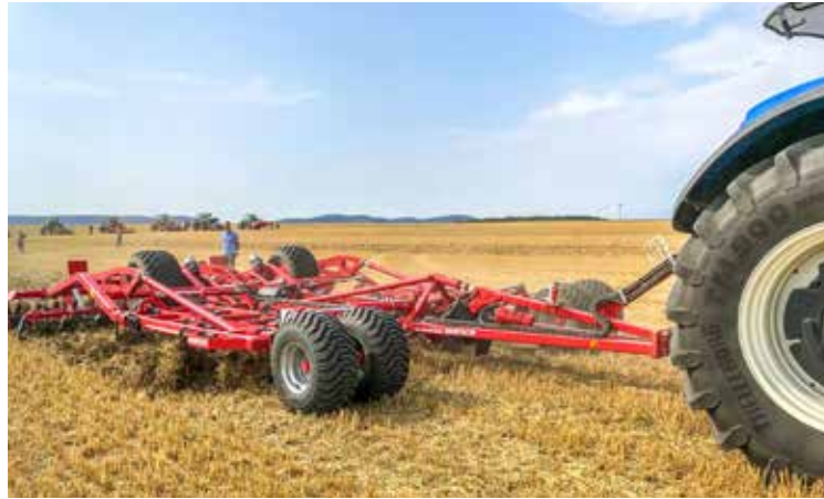
Flachgrubber mit Tiefenführungsradern zur ersten flachen Stoppelbearbeitung
