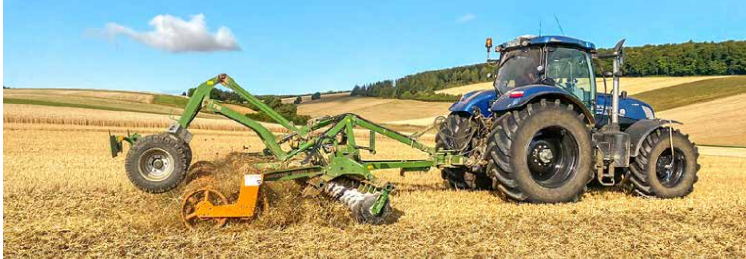
Kurzscheibenegge mit Doppel-Uprofilwalze und Fahrwerk zur ersten flachen Stoppelbearbeitung
