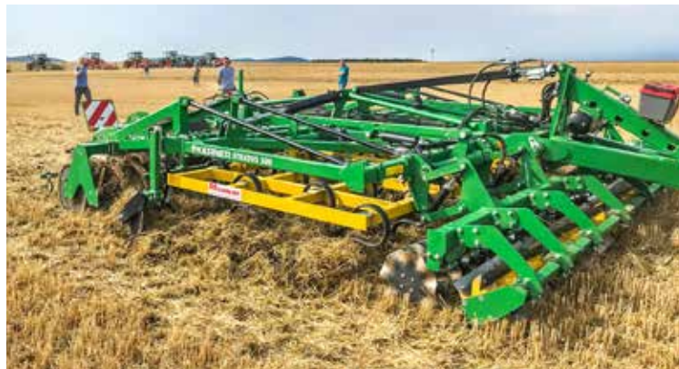
Flachgrubber mit Cutterwalze zur Vorzerkleinerung von Erntereststoffen bei der ersten flachen Stoppelbearbeitung
