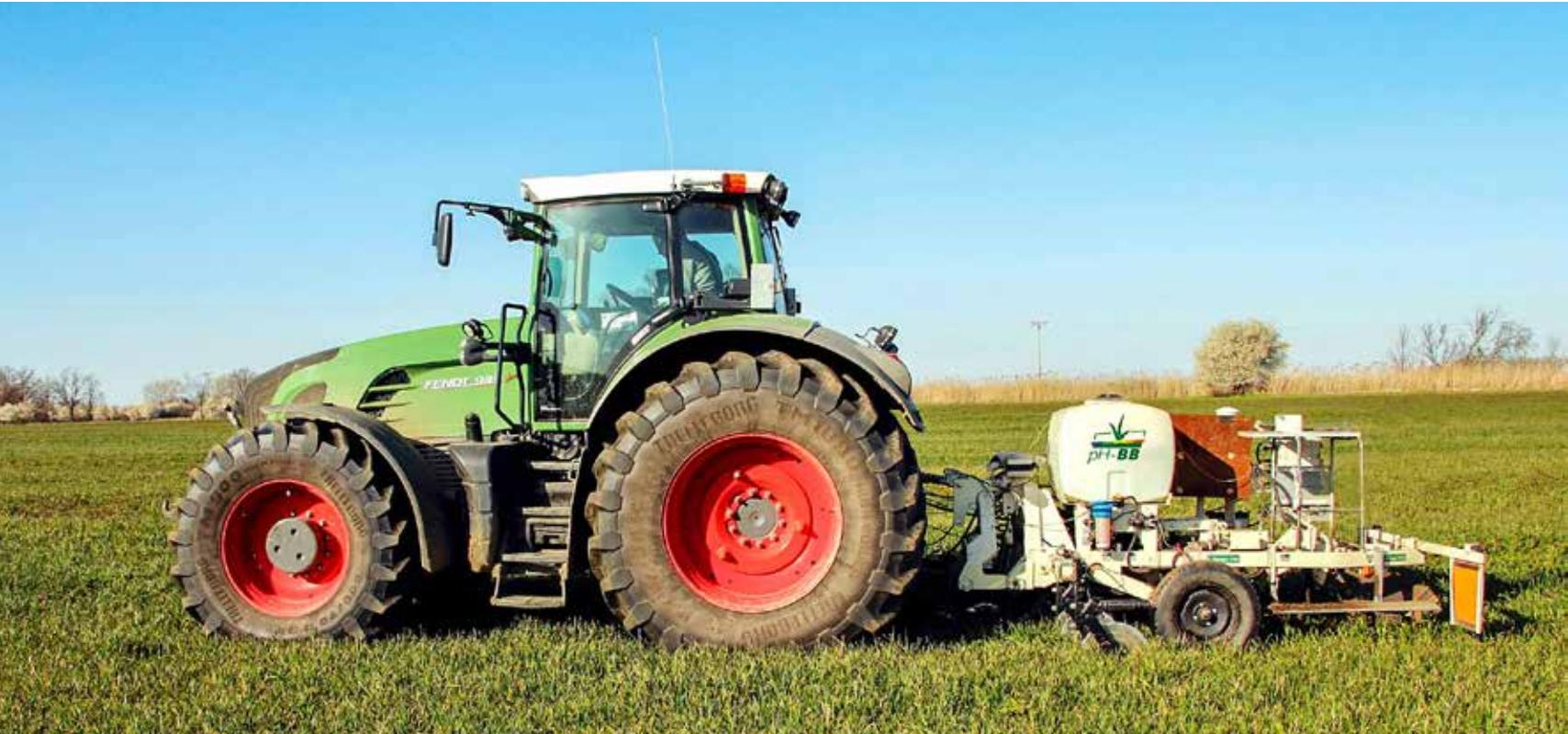
Eine kontinuierliche Aufzeichnung mit drei Sensoren bei einer Überfahrt ermöglicht die Multisensorplattform MSP3 (Veris) mit elektrischer Leitfähigkeit, Antimon-pH-Elektroden und optischem Sensor. Foto: Dr. Sebastian Vogel
