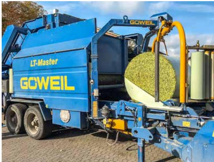
Bei der LT Master von Göweil gleitet der fahrbare Wickeltisch unter die Presse und übernimmt den mit vier Lagen Mantelfolie umwickelten Ballen. Während in der Kammer schon der nächste Ballen gepresst wird, sorgt der Doppelwickelarm für das Einstretchen des Ballens. Fotos: Dr. Susanne Ohl
