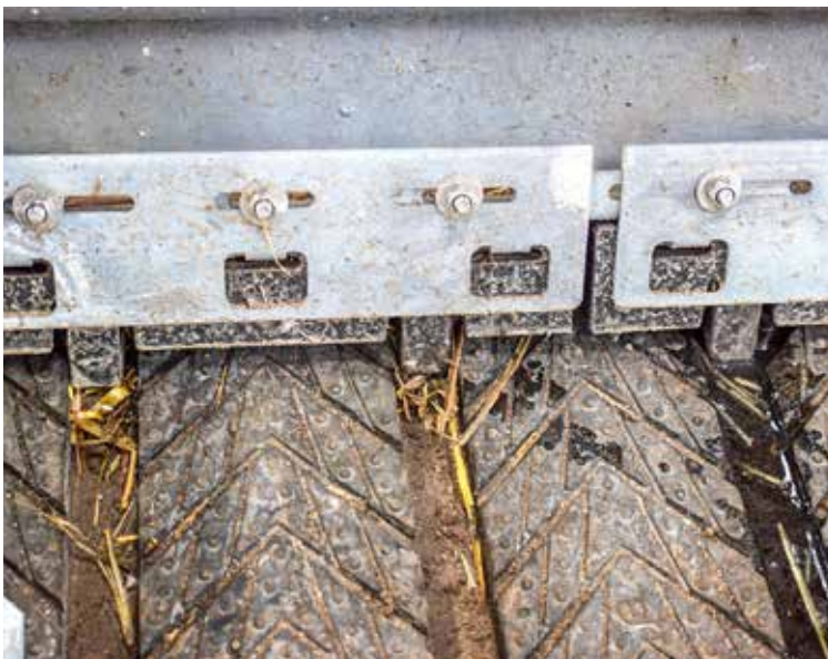
Der Gülleschieber reinigt die Rillen mit einer Gummizahnleiste.
