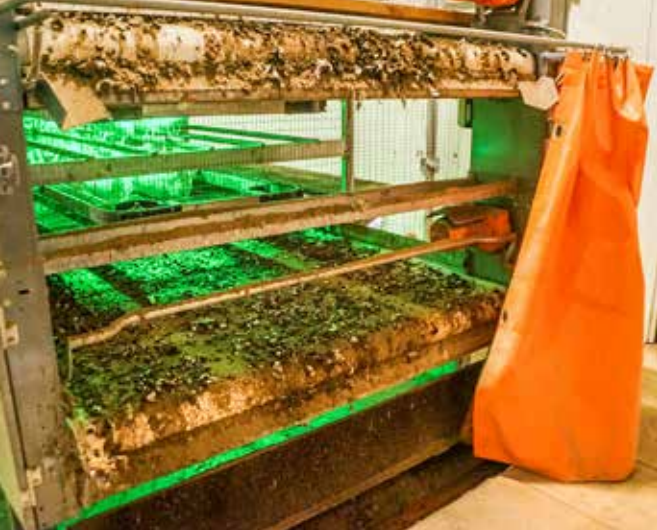
Abwurf des getrockneten Kotes aus dem Querförderband Fotos: Michael Götz
