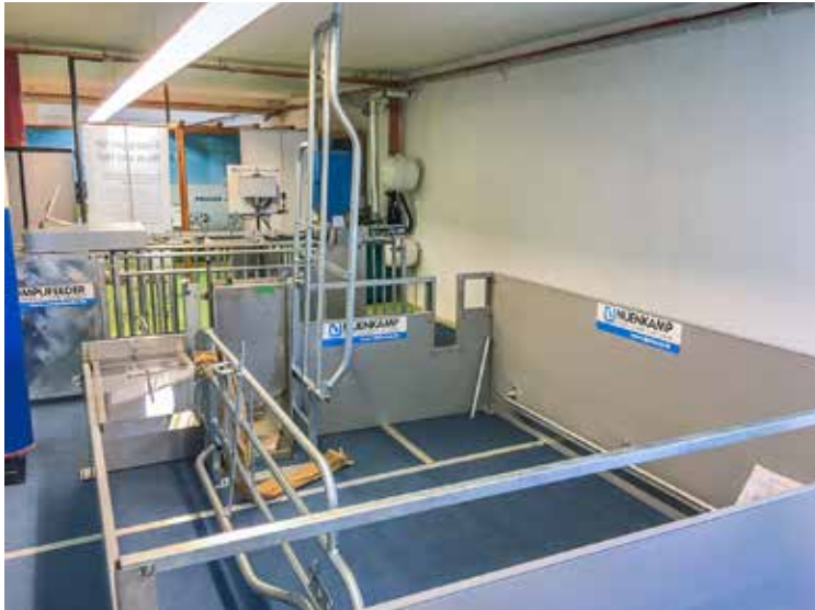
Die Nijenkamp-Bewegungsabferkelbucht ist aus der Praxis heraus entstanden: Zum Öffnen des Ferkelschutzkorbes werden die Seitenteile einfach nach oben geklappt. Fotos: Hans-Jochim Rohweder
