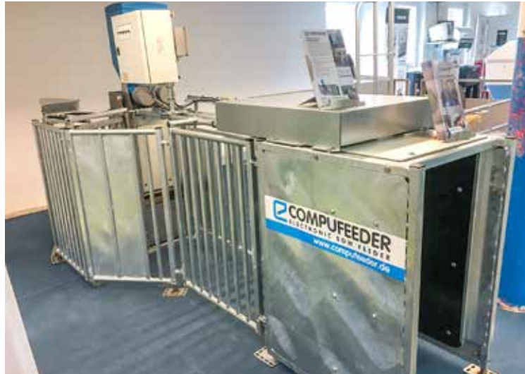
Bei der Abruffutterstation von Nijenkamp soll das offene System den Tunneleffekt verhindern.
