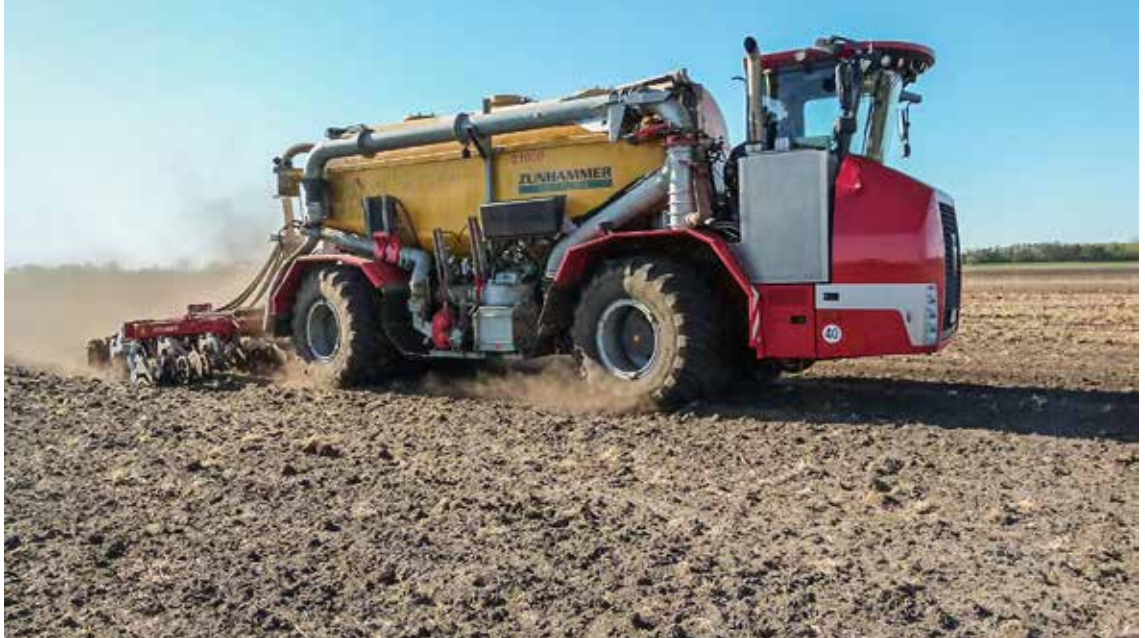
Durch Gülle-Strip-Till kann der Einsatz von flüssigen Wirtschaftsdüngern zu Silomais besonders N-effizient gestaltet werden. Foto: Peter Lausen
