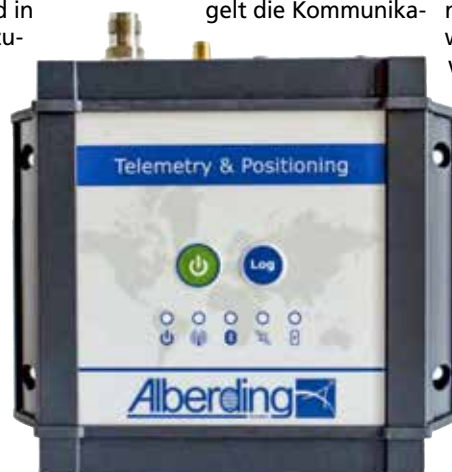
„Treck Dat Mol“-Datenrouter zur Echtzeitdatenaufnahme auf Landmaschinen
