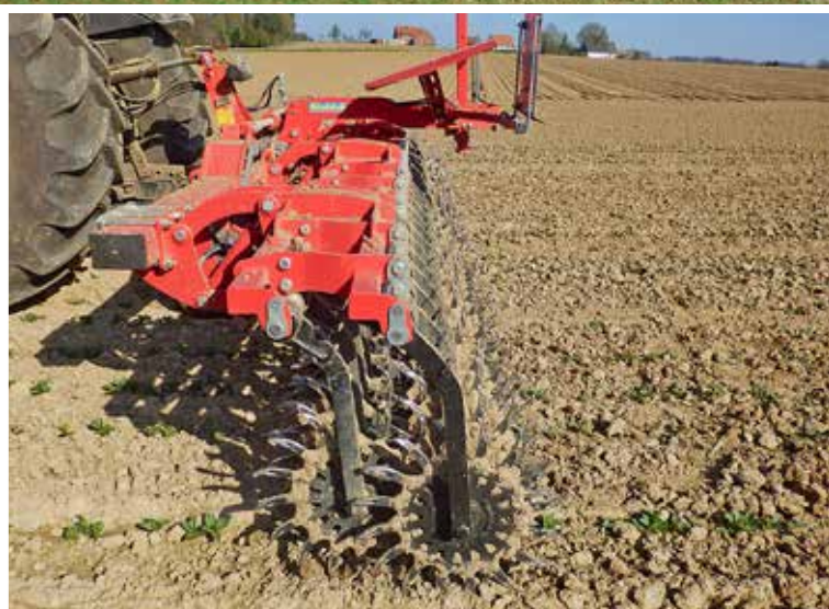
Die Sternrollhacke kann verkrustete oder verschlammte Böden sehr gut aufllockern und passt besonders auf lehmige Standorte.
