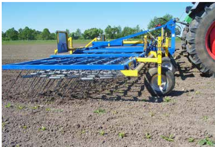
Zinkenstriegel mit indirekter Federung besitzen eine sehr gute Bodenangepassung und Kulturschonung ...
