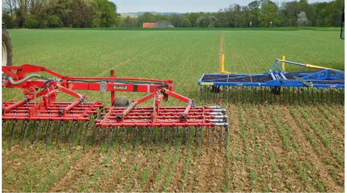
Bei der Striegeltechnik werden Systeme mit direkter und indirekter Federung der Zinken angeboten.
