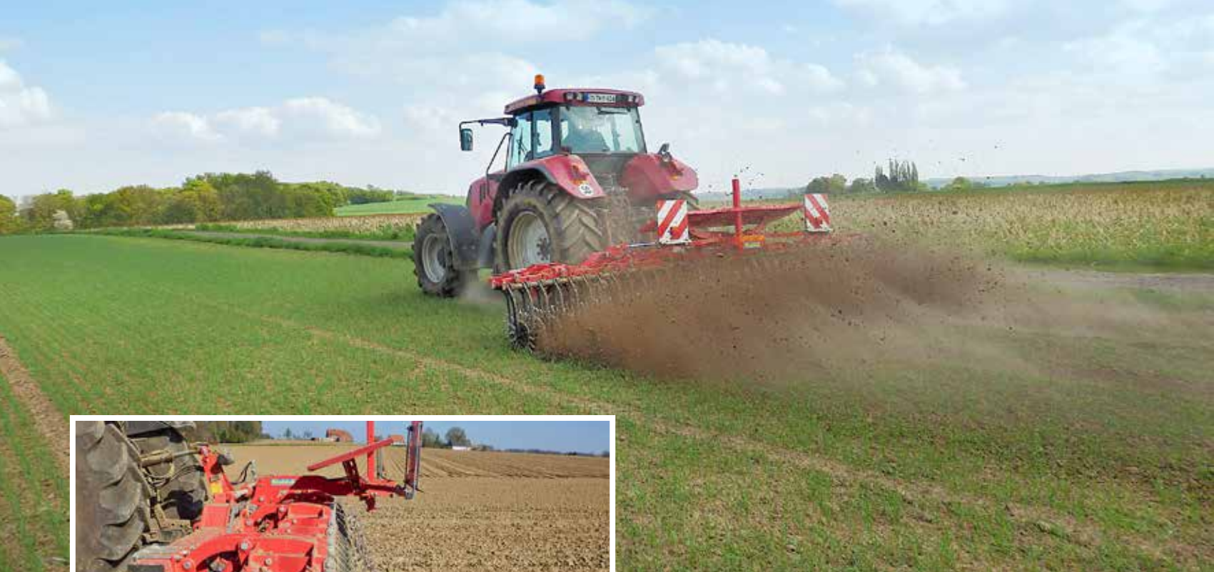
Die Sternrollhacke kann verkrustete oder verschlammte Böden sehr gut aufllockern und passt besonders auf lehmige Standorte.
