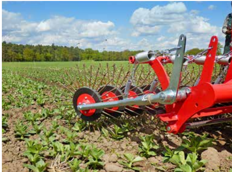
Bei der Rollstriegeltechnik sind die Werkzeuge schräg angeordnet. Sie ist in der Praxis aber noch nicht sehr verbreitet.
