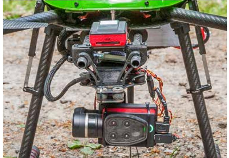
Die Multispektralkamera ist mit der Drohne über ein selbstständig austarierendes Gimbal verbunden.
