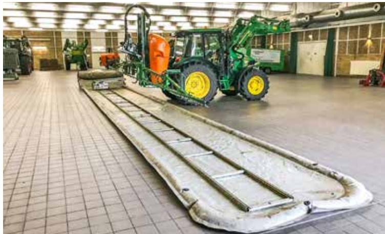
Prüfungen auf mobilen Prüfständen dienen der amtlichen Kontrolle von Pflanzenschutzgeräten. Nur exakt arbeitende, geprüfte Pflanzenschutzgeräte gewährleisten sicheren und wirksamen Pflanzenschutz.
