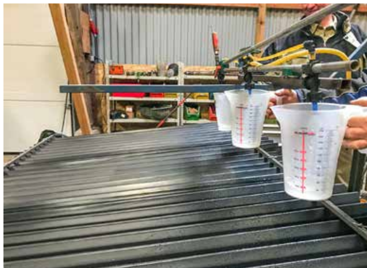
Das Auslitern der einzelnen Düsen gibt vor und während der Saison Auskunft über den exakten Flüssigkeitsausstoß. Die Querverteilung muss am Prüfstand genau ermittelt werden. Fotos: Dr. Wolfgang Pfeil
