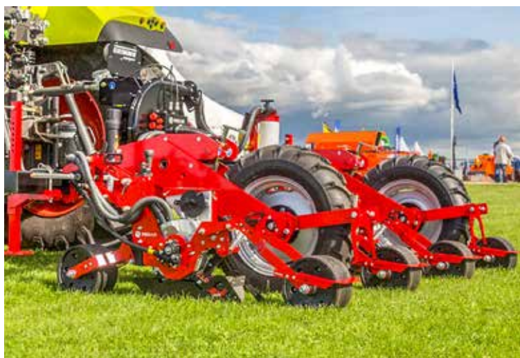
Der Antrieb der Säelemente erfolgt mittels wartungsfreier biegsamer Wellen. Ein Säelement kann eine bis vier Säreihen ablegen.
