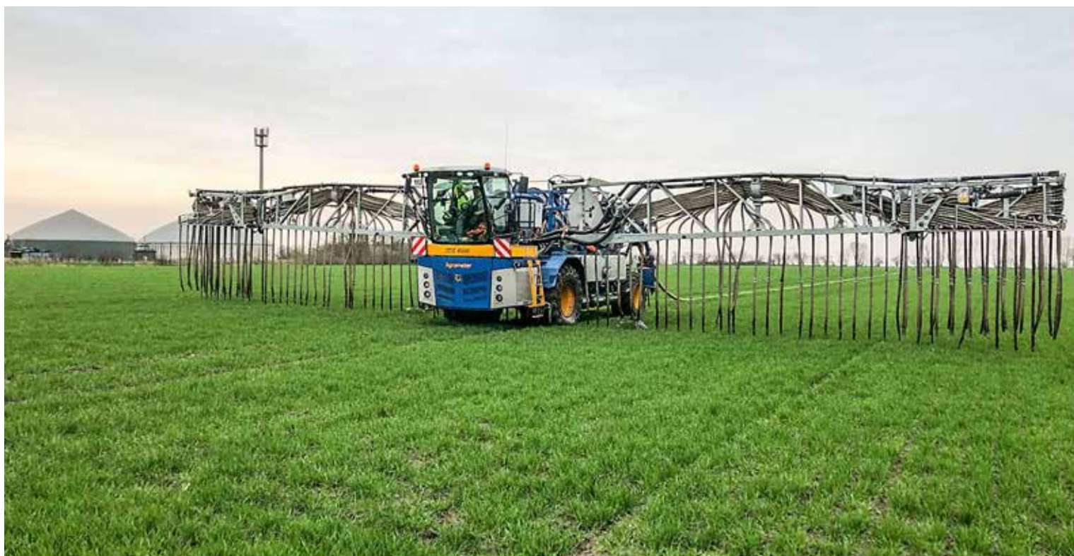
Düngungsmaßnahmen im Getreideanbau mit Gülle und Gärresten zum frühen Termin können durch Verschlauchung emissionsarm, bodenschonend und flexibel durchgeführt werden. Foto: Henning Schuch
