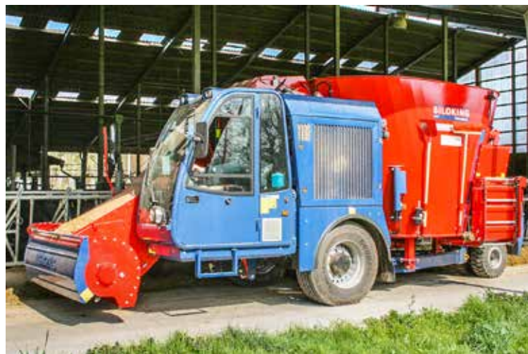
Der Futtermischwagen sollte regelmäßig kontrolliert und gewartet werden. Funktioniert die Waage richtig? Müssen Messer ausgetauscht werden?
