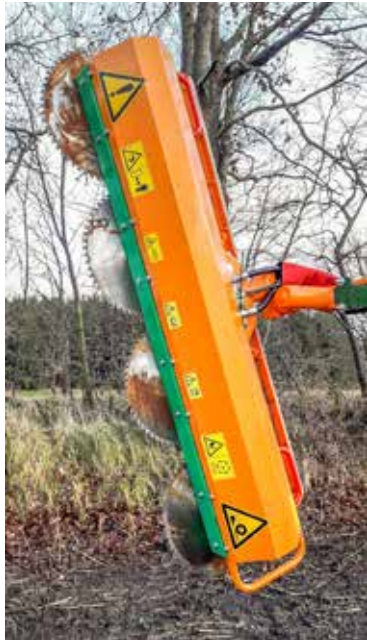
Knicksäge im praktischen Einsatz beim seitlichen Aufputzen des Knicks
