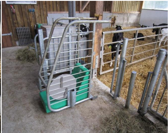
Abb. 16 b: Die Abrufstationen lassen sich auf den Futtertisch klappen, damit sie beim Entmisten kein Hindernis darstellen.
