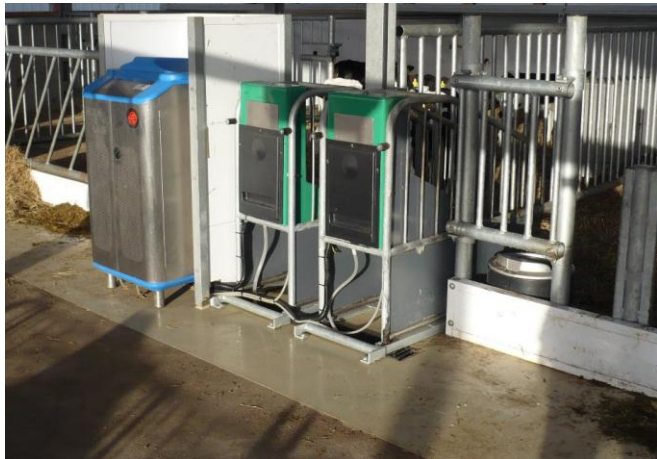
Abb. 16a: Auf dem vier Meter breiten Futtertisch lässt sich problemlos ein Tränkeautomat installieren.
