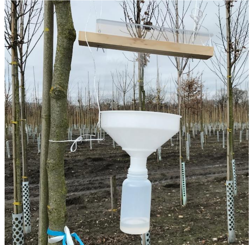
Trichterfalle der Fa. Grossmann Regendach und Prallscheibe aus Plexiglas
